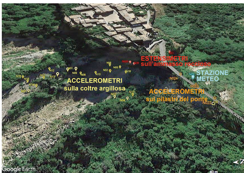
Figura 4 Posizionamento dei sensori (prima configurazione).
