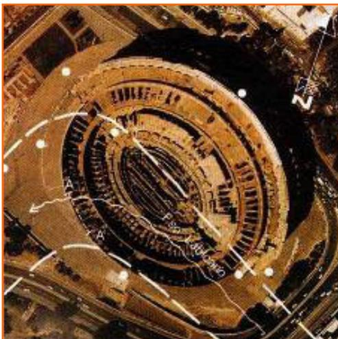
Figura 13 La parte più danneggiata del Colosseo ha le fondazioni sui depositi alluvionali del Fosso Labicano: ciò comporta maggiori sollecitazioni (a causa dell'amplificazione del moto sismico) rispetto alla parte che poggia su depositi più antichi e più duri.
